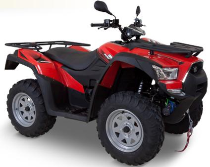
**Moteur :** Monocylindre 694,6 cm3, 4T, injection, refroidissement liquide
